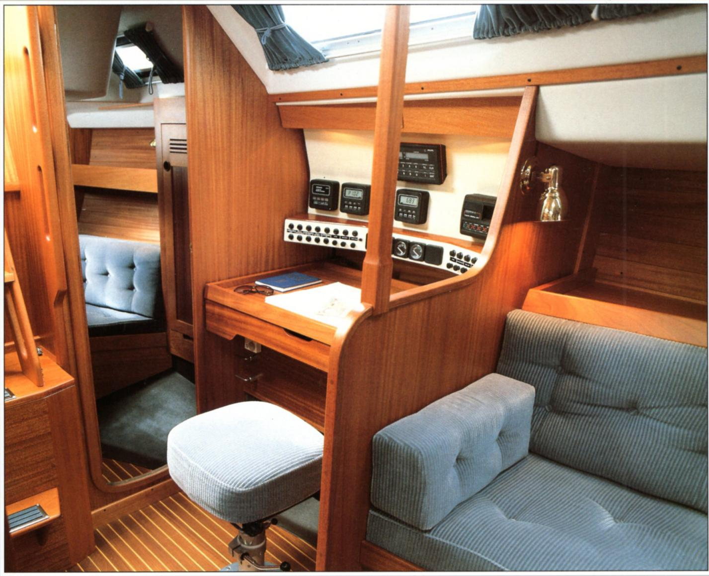
Der Kartentisch ist geräumig und von beispielhafter Übersichtlichkeit. Das Instrumentenpanel ist herausklappbar und bietet unbehinderten Zugang für Service und Kontrolle. Besondere Fächer sind vorgesehen für Navigationsbesteck und Seekarten sowie für den unentbehrlichen Kleinkram. Der Lieblingsplatz des Skippers! Direkt anschließend, die Eignerkabine, groß und geräumig, mit einer Doppelkoje von königlichem Ausmaß, mit Sitzecke, Kleiderschrank und Regalen. Hell, luftig und komfortabel.
