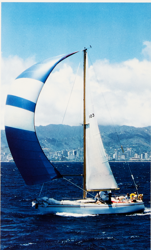
YAMAHA-36 L.O.A. .... 35'1" (10.95m) L.W.L. .... 29'1" (8.86m) Beam .... 11'9" (3.61m) Displacement .... 5,700 kg Draft .... 6'7" (2.00m) Ballast .... 2,550 kg Sail Area .... 611 sq.ft (56.80m 2 )
