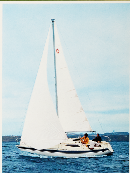
YAMAHA-25 L.O.A. .... 24'9" (7.55m) L.W.L. .... 19'3" (5.87m) Beam .... 8'11" (2.73m) Displacement .... 1,700 kg Draft .... 4'3" 5'5" (1.30 1.65m) Ballast .... 650 kg Sail Area .... 283 sq.ft (26.29m 2 )
