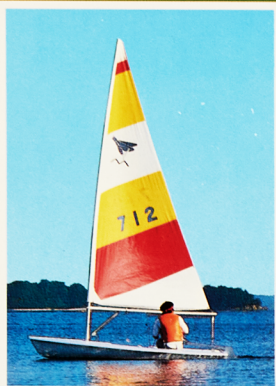
YAMAHA-11 Mini Hopper L.O.A. .... 11'3" (3.43m) L.W.L. .... 10'4" (3.16m) Beam .... 4'2" (1.32m) Draft C-B up down ... 4" 2'5" (0.10 0.75m) Sail Area .... 55.76 sq.ft (5.18m 2 )
