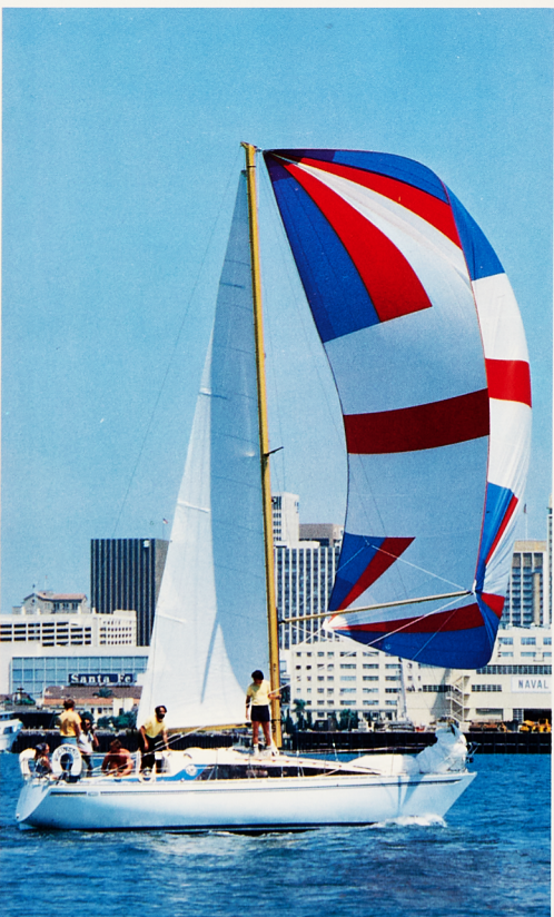
YAMAHA-33 L.O.A. .... 33'5" (10.17m) L.W.L. .... 26'11" (8.20m) Beam .... 11'0" (3.35m) Displacement .... 4,400 kg Draft .... 6'3" (1.90m) Ballast .... 2,000 kg Sail Area .... 492 sq.ft (45.70m 2 )
