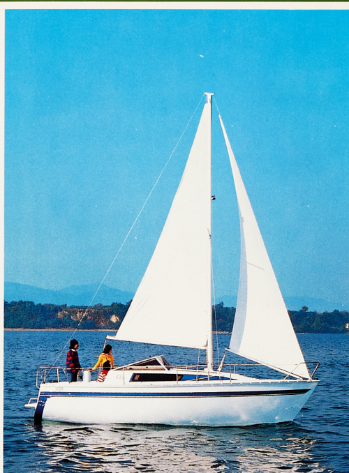
YAMAHA-24MS L.O.A. .... 24'4" (7.42m) L.W.L. .... 21'4" (6.50m) Beam .... 8'6" (2.59m) Displacement .... 1,650 kg Draft .... 2'11" (0.90m) Ballast .... 650 kg Sail Area .... 201 sq.ft (18.67m 2 ) Recommended Output .... 8 hp
