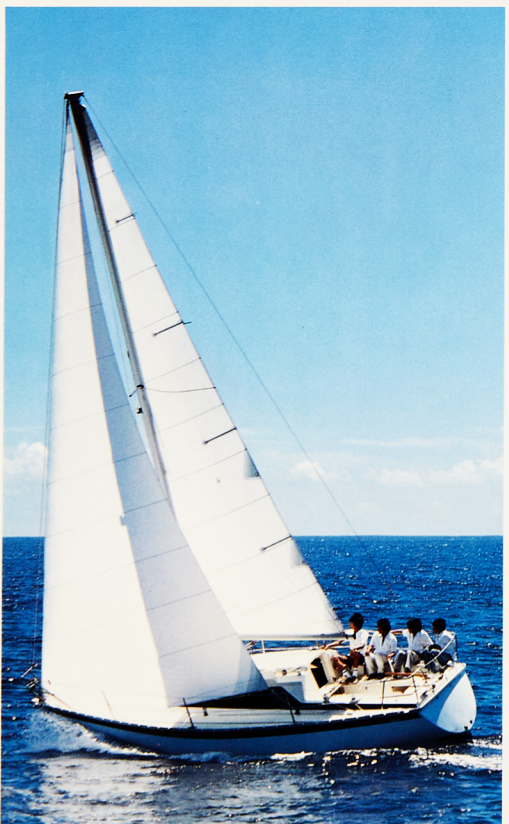
YAMAHA-30 L.O.A. .... 29'5" (8.97m) L.W.L. .... 23'7" (7.20m) Beam .... 10'7" (3.23m) Displacement .... 3,450 kg Draft .... 5'9" (1.75m) Ballast .... 1,300 kg Sail Area .... 391 sq.ft (36.27m 2 )
