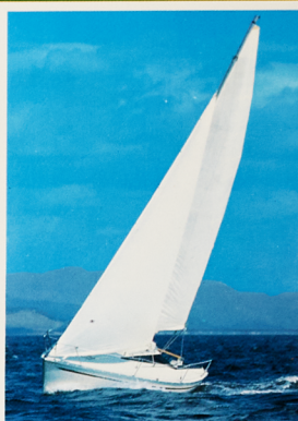
YAMAHA-21R.C L.O.A. .... 20'8" (6.30m) L.W.L. .... 17'5" (5.30m) Beam .... 9'4" (2.85m) Displacement .... 900 kg Draft C-B up down ... 4'5" (1.35m) Ballast .... 300 kg Sail Area .... 194 sq.ft (18.02m 2 )
