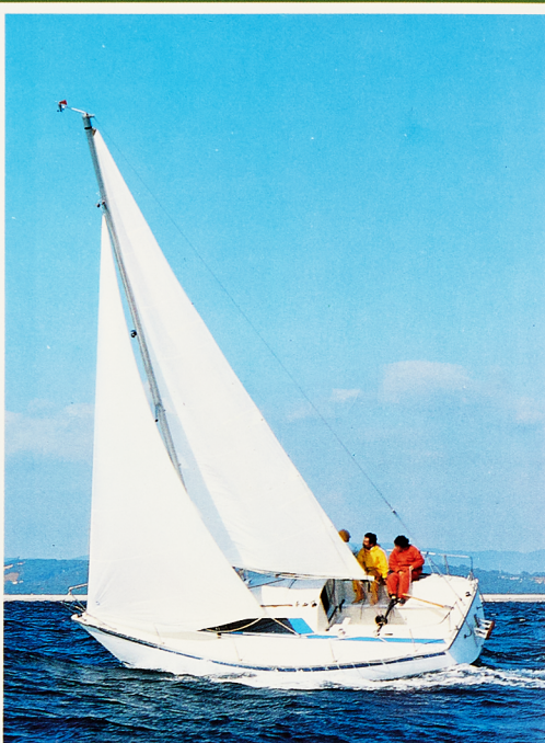
YAMAHA-24 tonner L.O.A. .... 24'3" (7.40m) L.W.L. .... 20'3" (6.18m) Beam .... 10'0" (3.05m) Displacement .... 1,400 kg Draft .... 5'1" (1.55m) Ballast .... 415 kg Sail Area .... 242.8 sq.ft (22.56m 2 )
